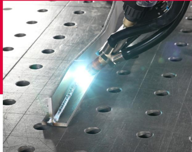
Der **automatische Nahtverfolgungssensor** erkennt Bauteilveränderungen in Echtzeit, passt den Schweißprozess dynamisch an und reduziert durch die automatische Bauteilerkennung den Programmieraufwand deutlich.
