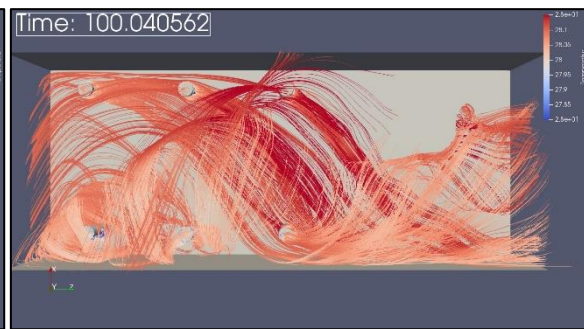
Abbildung 18 – Draufsicht mit Strömungslinien, Färbung nach Temperatur
